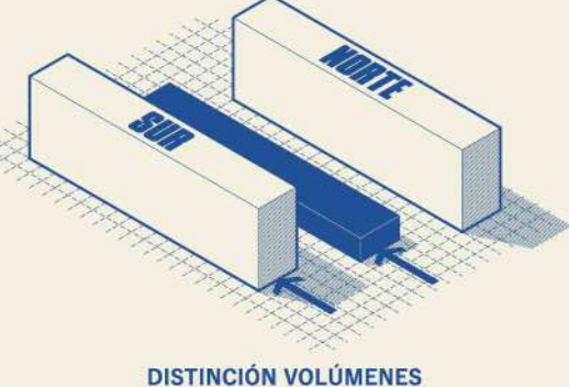
DISTRIBUCIÓN VOLUMENES Se obtienen 2 piezas que contienen las cápsulas habitacionales y 1 pieza central de espacios comunes que desplazadas unas de otras generan los accesos y recorridos.
